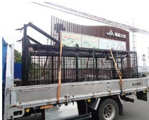
製作したヒグマ用箱わな 幅1.3×高さ1.3m×長さ4m
