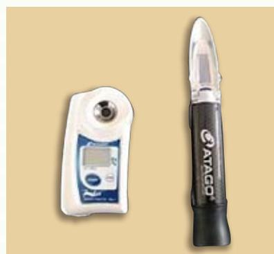
写真1 デジタル糖度計(左) 屈折糖度計(右)
