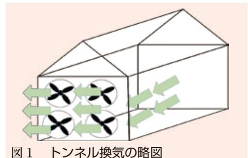
図1 トンネル換気の略図
