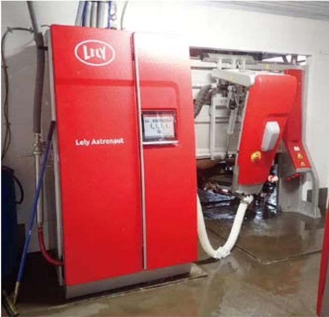
市川牧場に導入された、搾乳ロボットアストロノートA5
